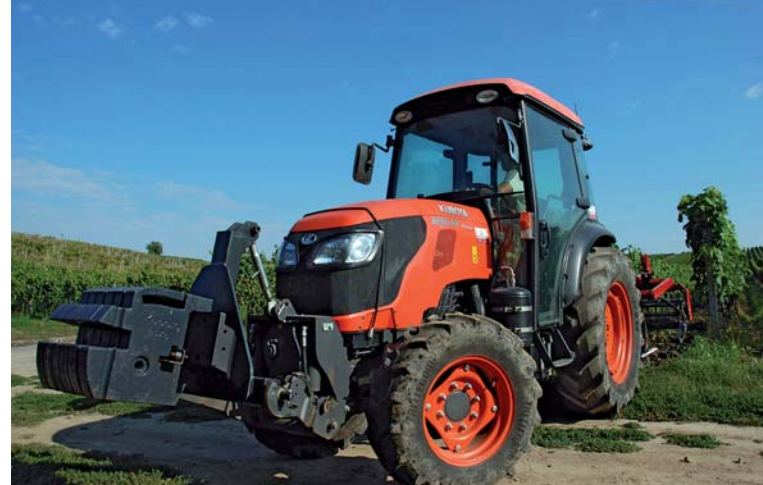
Kubota M9540 Narrow je pětadevadesátikoňový silák, s čelním tříbodovým závěsem a dobrými tahovými vlastnostmi
