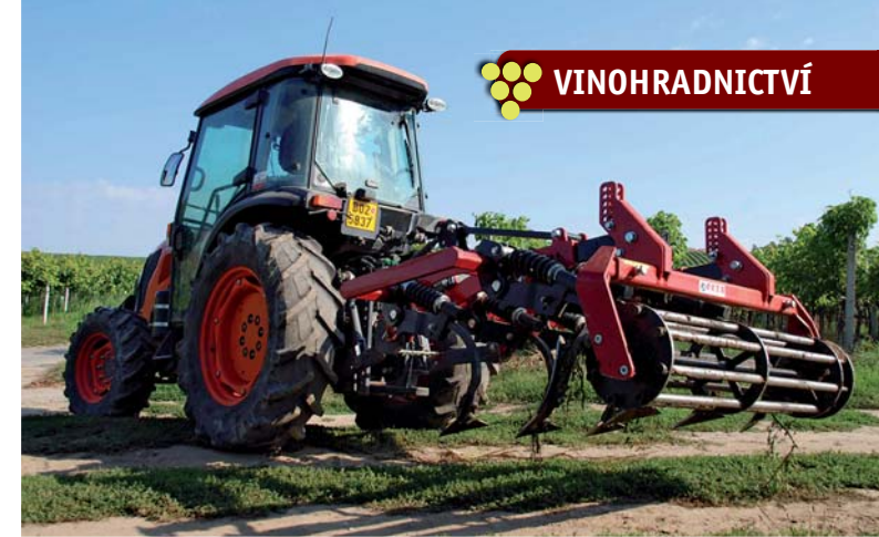
Kubota M9540 Narrow je pětadevadesátikoňový silák, s čelním tříbodovým závěsem a dobrými tahovými vlastnostmi
