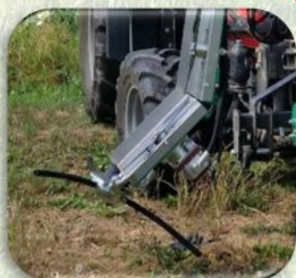
Coltello sylvose con motore idraulico Inc.(45°)
